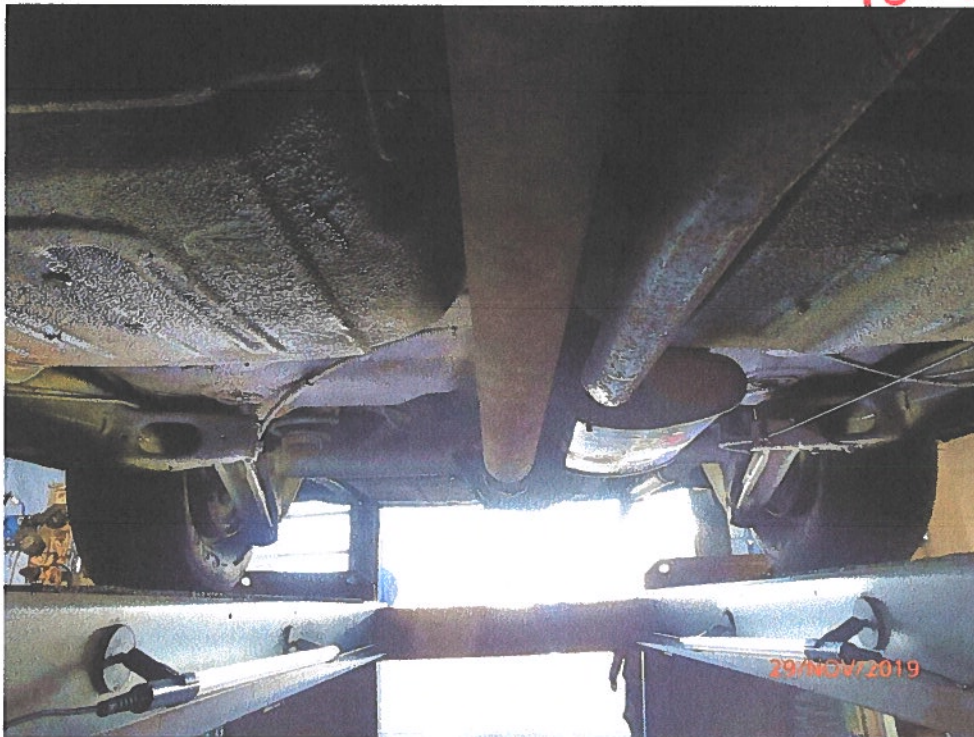
Foto 022: Unterboden, Sicht zur Hinterachse, Kardanwelle, Abgastopf
