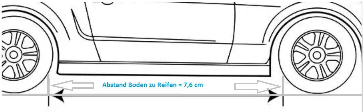
Schritt 2: Messen Sie den Abstand zwischen diesen beiden Punkten. Ziehen Sie davon 5 Zentimeter ab. Dieser Wert muss größer sein als der Wert  $I = \text{„Frame Length“}$  in den Dokumenten von QuickJack
