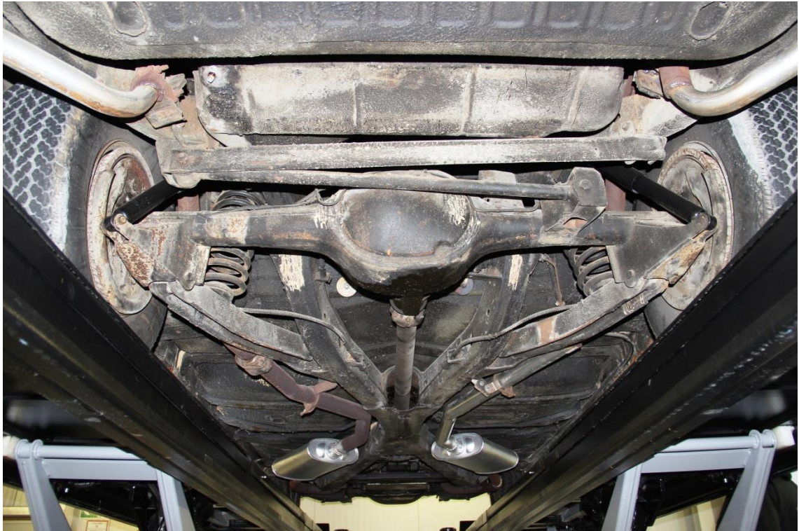
Bild 9: Pkw des Auftraggebers: Zustand der Bodengruppe im Bereich der Hinterachse
