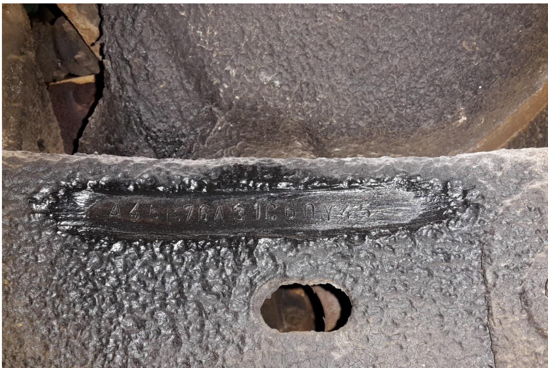
Bild 3: Pkw des Auftraggebers: Fahrzeugidentifizierung anhand der als zusätzliche Fahrzeug-Ident.-Nr. am vorderen rechten Rahmenlängsträger in Höhe der Vorderachse eingebrachten bzw. eingeschlagenen Buchstaben- und Ziffernfolge
