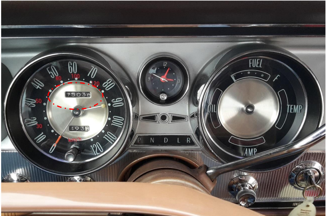
Bild 5: Pkw des Auftraggebers: Ermittlung der Gesamtleistung anhand der Anzeige des in den Geschwindigkeitsmesser bzw. Tachometer integrierten Wegstreckenzählers
