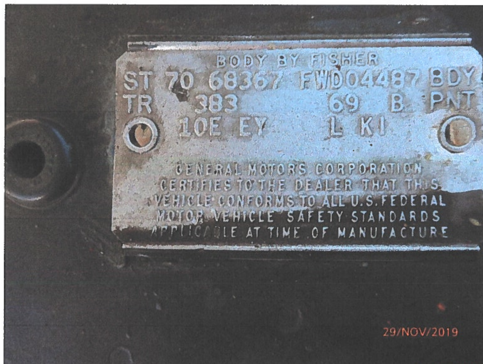
Foto 019: Herstellerplakette des Karosseriebau Fisher Body
