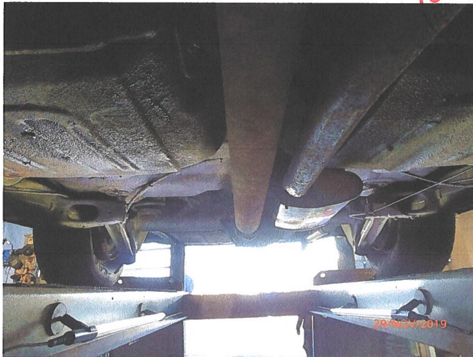
Foto 022: Unterboden, Sicht zur Hinterachse, Kardanwelle, Abgastopf
