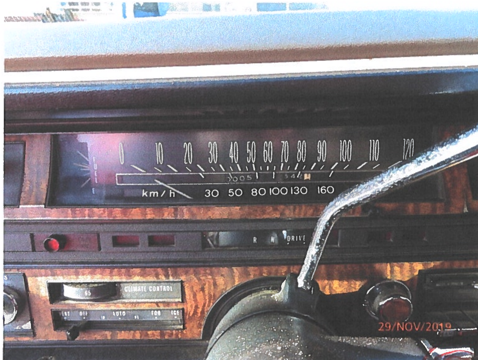
Foto 015: Fahrtstreckenzähler (1)00.051 Meilen und Hydra-Matic Schalthebel
