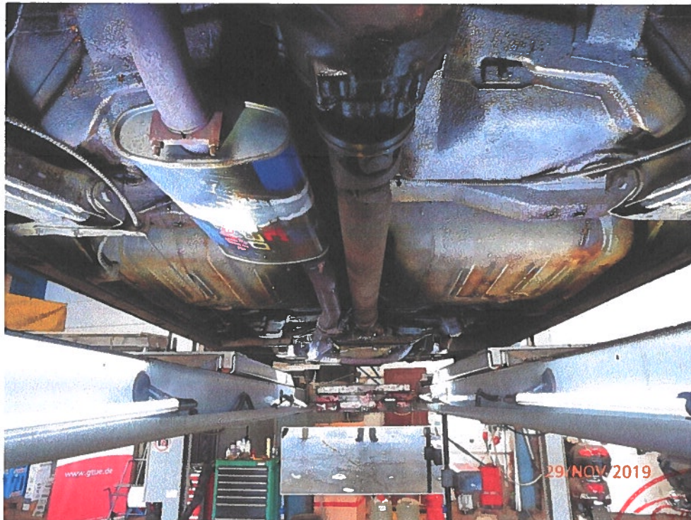
Foto 021: Unterboden, Abgasführung, Kardanwelle, Sicht auf Vorderachse
