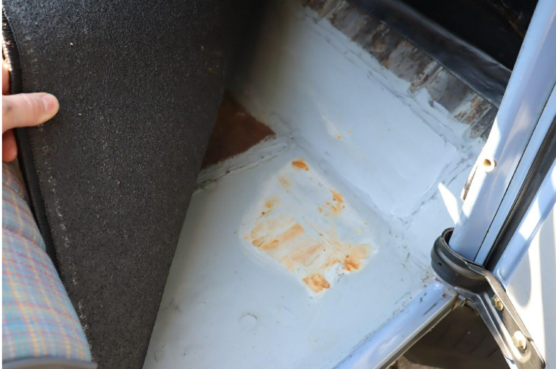
Bild 13 : Blechsubstanz im Beifahrerfußraum
