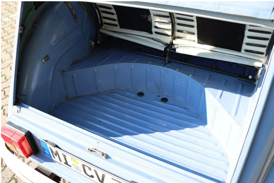
Bild 8 : Kofferraum Blechsubstanz am Fahrzeugheck
