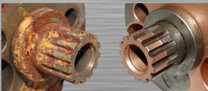
Diese Kurbelwelle einer Yamaha TZ500 Werksmaschine aus dem Jahr 1984 bekam dank der Aquablast-Reinigung wieder ihr ursprüngliches Aussehen zurück.
