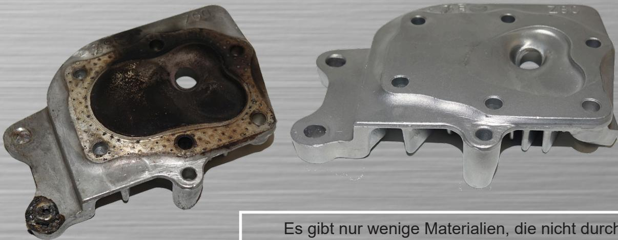
Es gibt nur wenige Materialien, die nicht durch Aquablasting behandelt werden können. Stahl, Aluminium, Magnesium, Kupfer und sogar Kohlefaserbauteile hingegen sind kein Problem.
