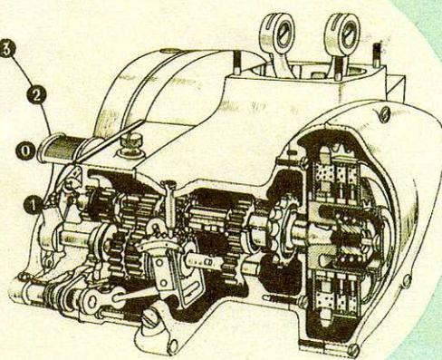
**Getriebe:** Viergang-Getriebe mit Ratschen-Fußschaltung und elektrischer Leerlaufanzeige im Scheinwerfer. Fußschalthebel linksseitig bequem angeordnet umlegbarer Fußstarter links, Mehrscheibenkupplung.
